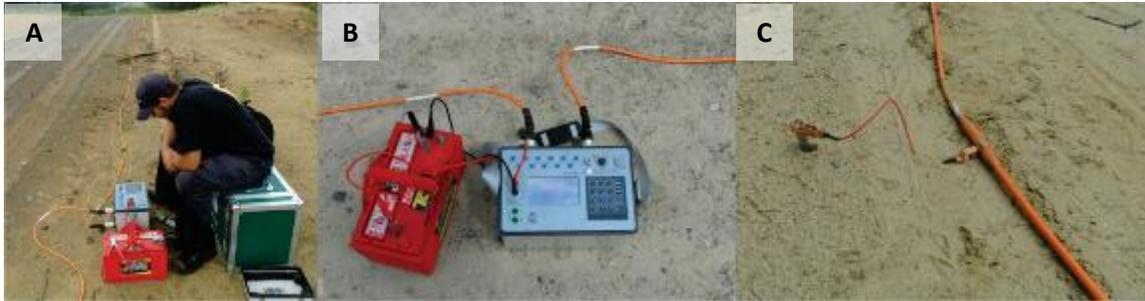
(A) Câbles déployés (360 m) et reliés à l'appareil localisé en position centrale; (B) Appareil alimenté par une pile externe; (C) Électrodes enfoncées dans le sol et reliées au câble central.
