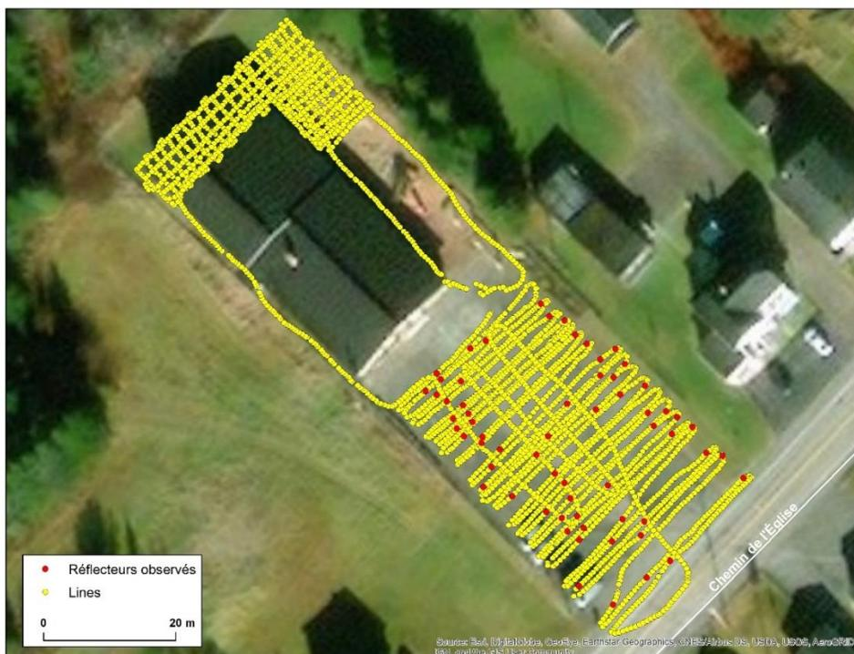
Figure 32 : Positions des profils de GPR géoréférencés et des différents points de références
